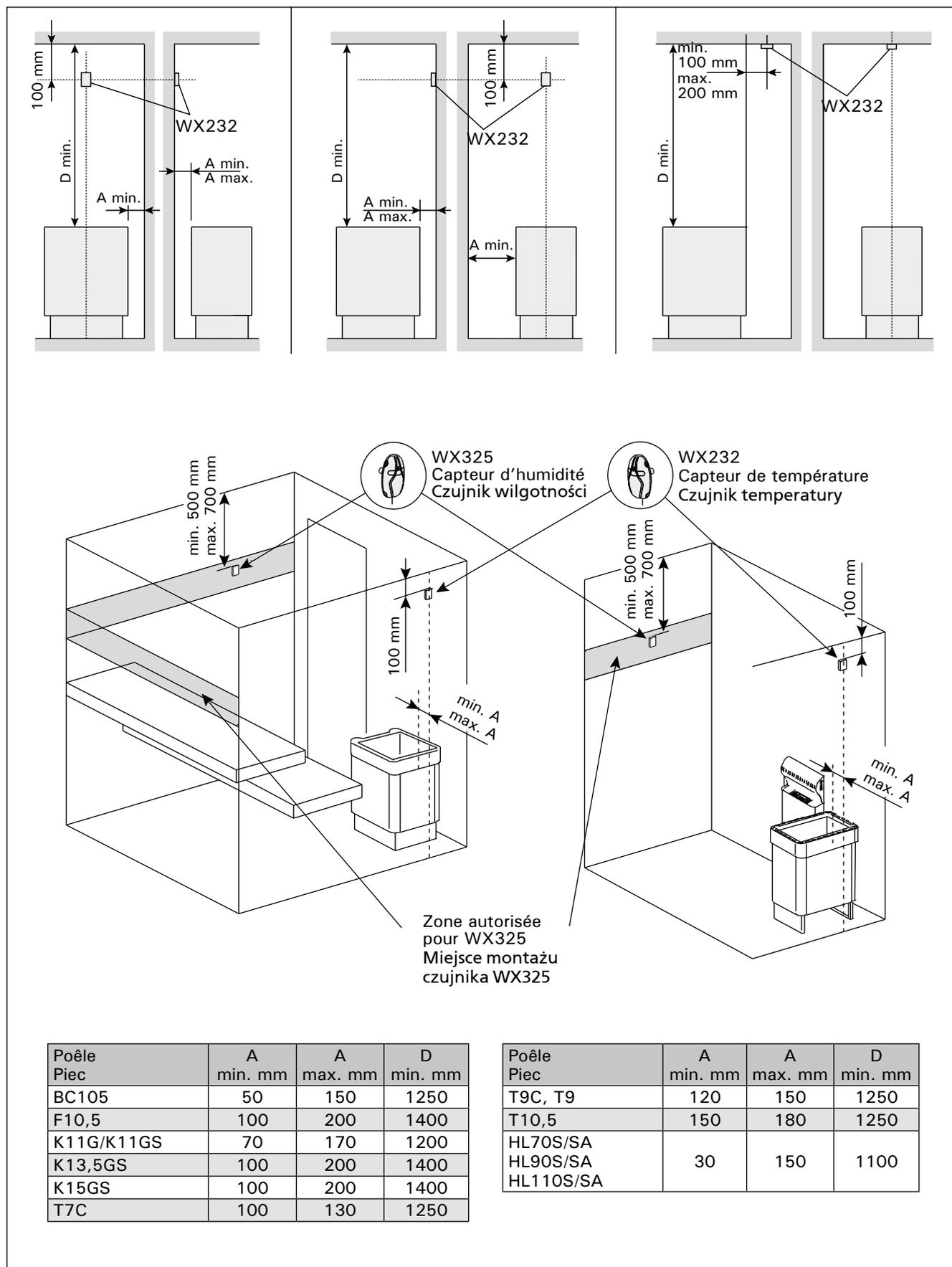
Figure 9. Emplacement des capteurs de température et d'humidité par rapport aux poêles en installation au sol
