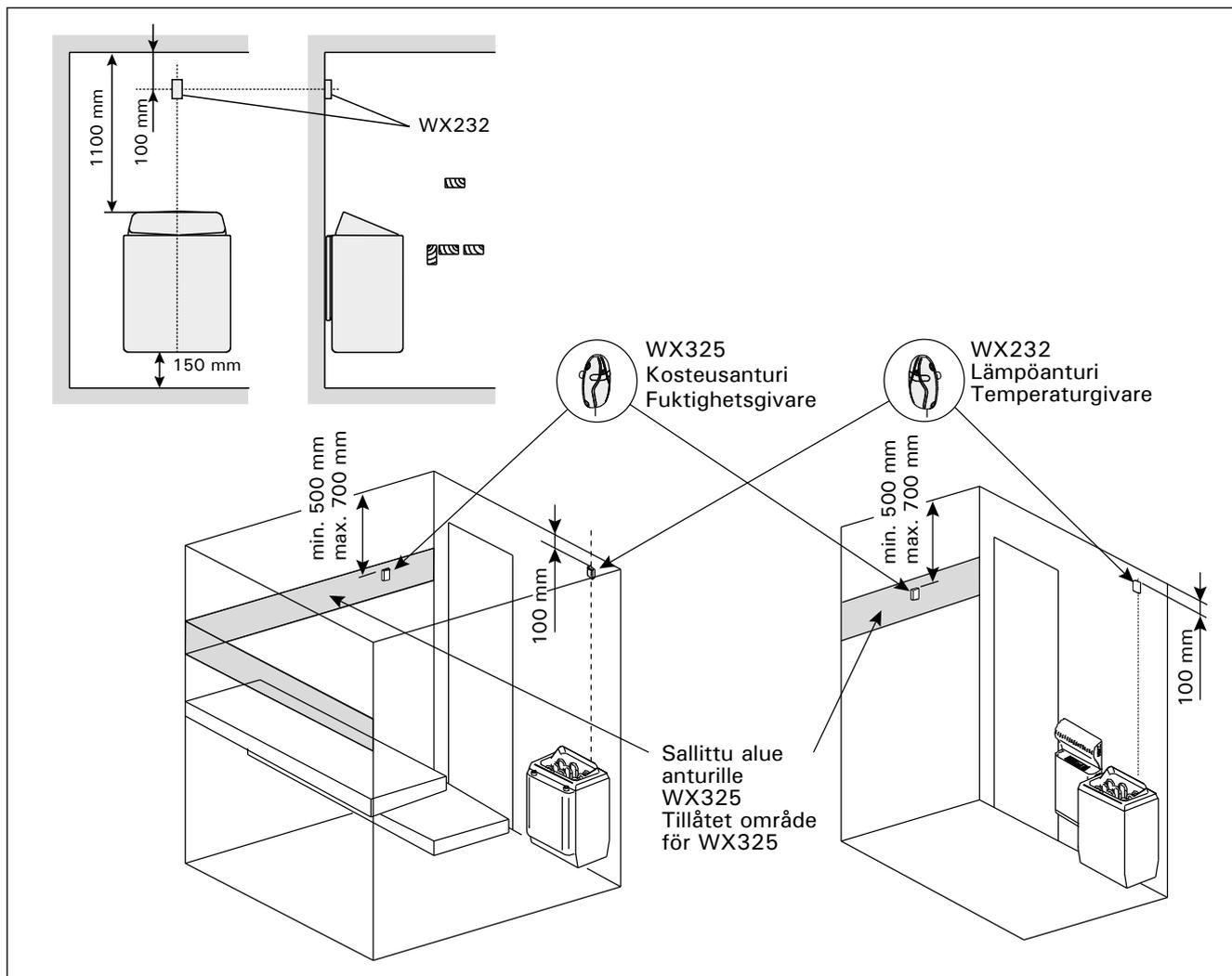
**Kuva 8. Lämpö- ja kosteusantureiden sijainti seinään kiinnitettävien kiukaiden yhteydessä**
