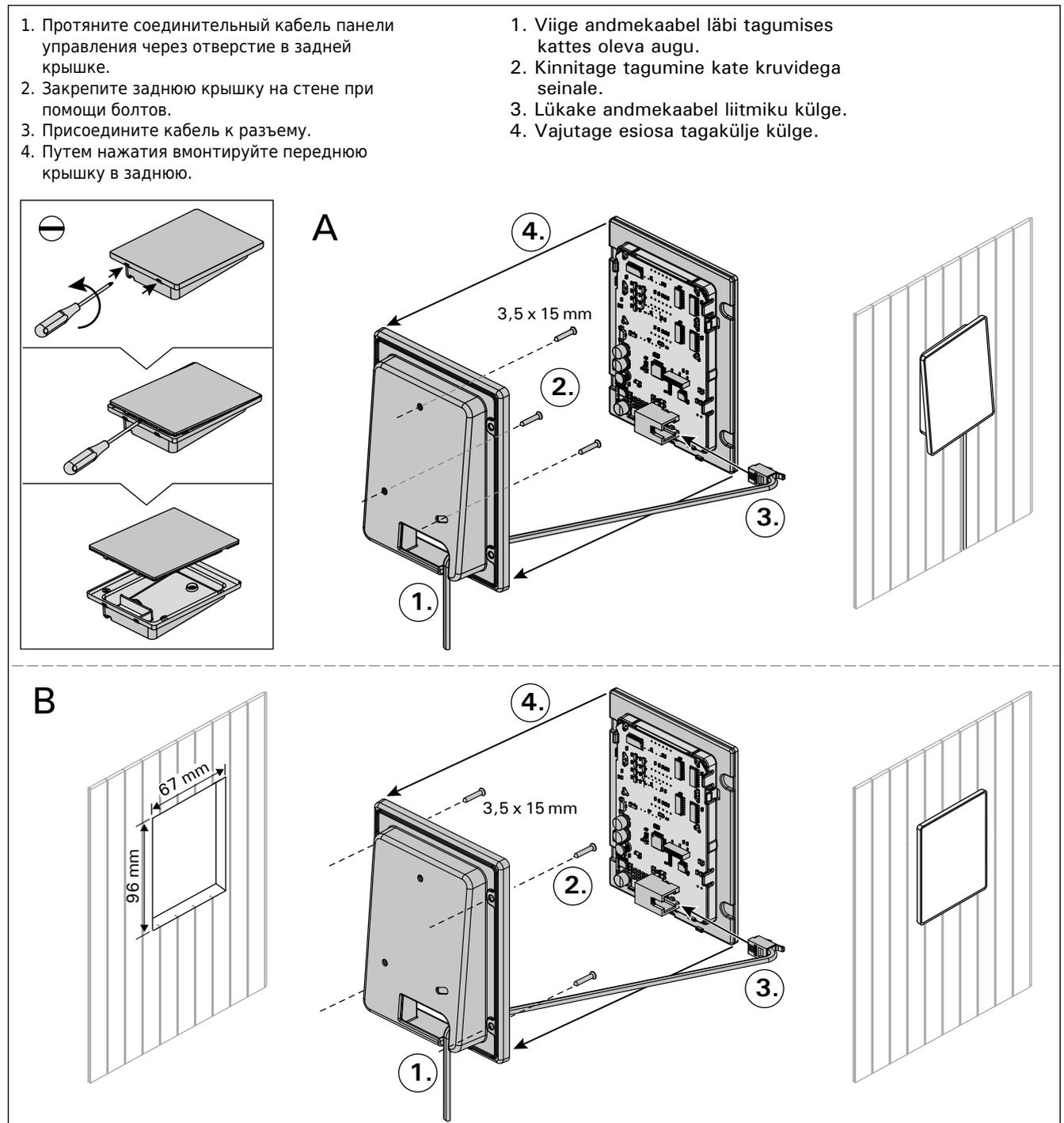
Рисунок 4. Установка панели управления
