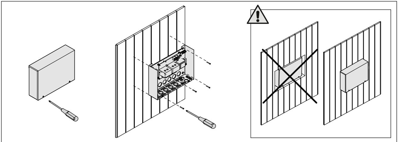
Figura 5. Apertura del coperchio dell'unità di alimentazione e montaggio dell'unità alla parete
