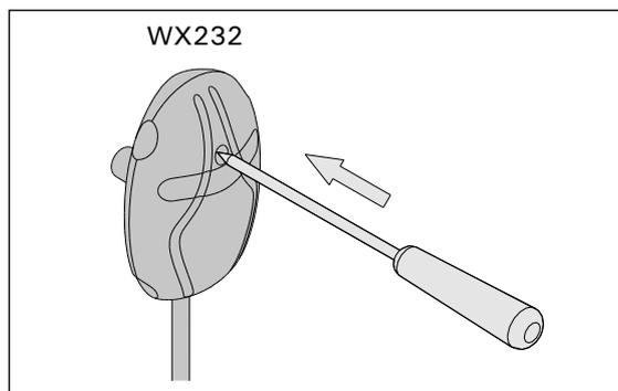
**Рисунок 11. Кнопка сброса защиты от перегрева**
