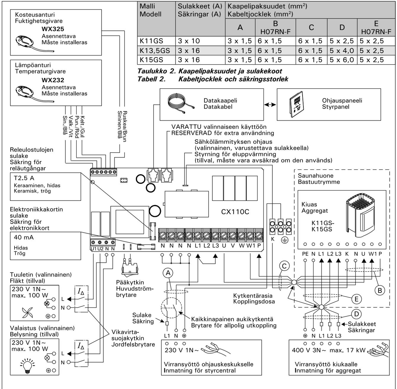
**Kuva 6. Sähkökytkennät (K11GS–K15GS)**
