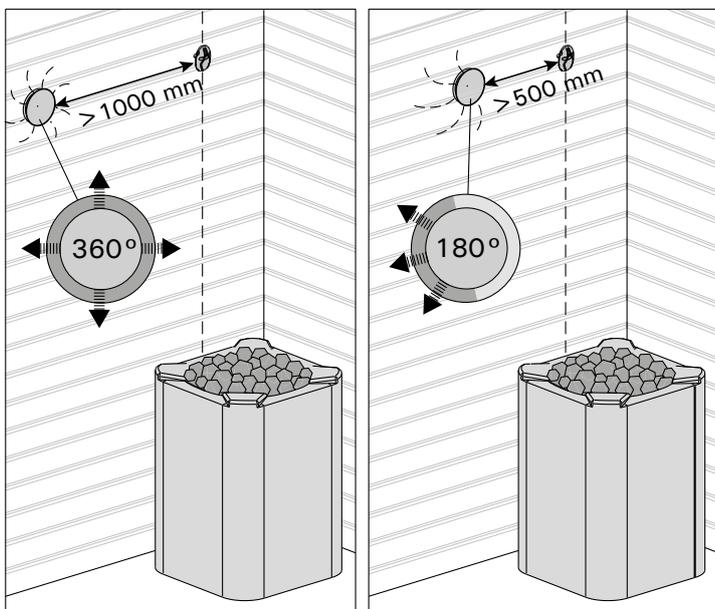
**Рисунок 10. Минимальное расстояние между датчиком и вентилятором**
