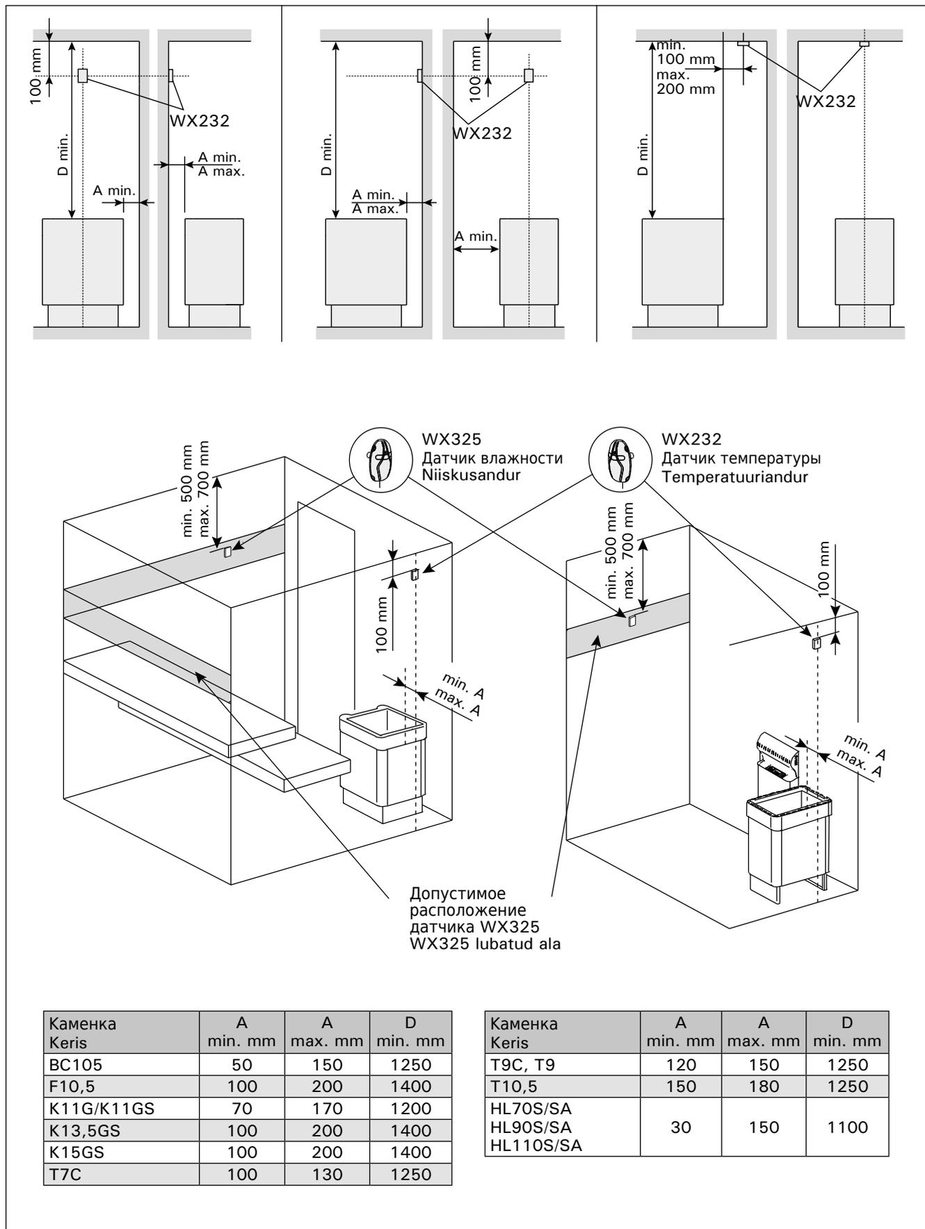
Рисунок 9. Расположение датчиков температуры и влажности относительно напольных нагревателей
