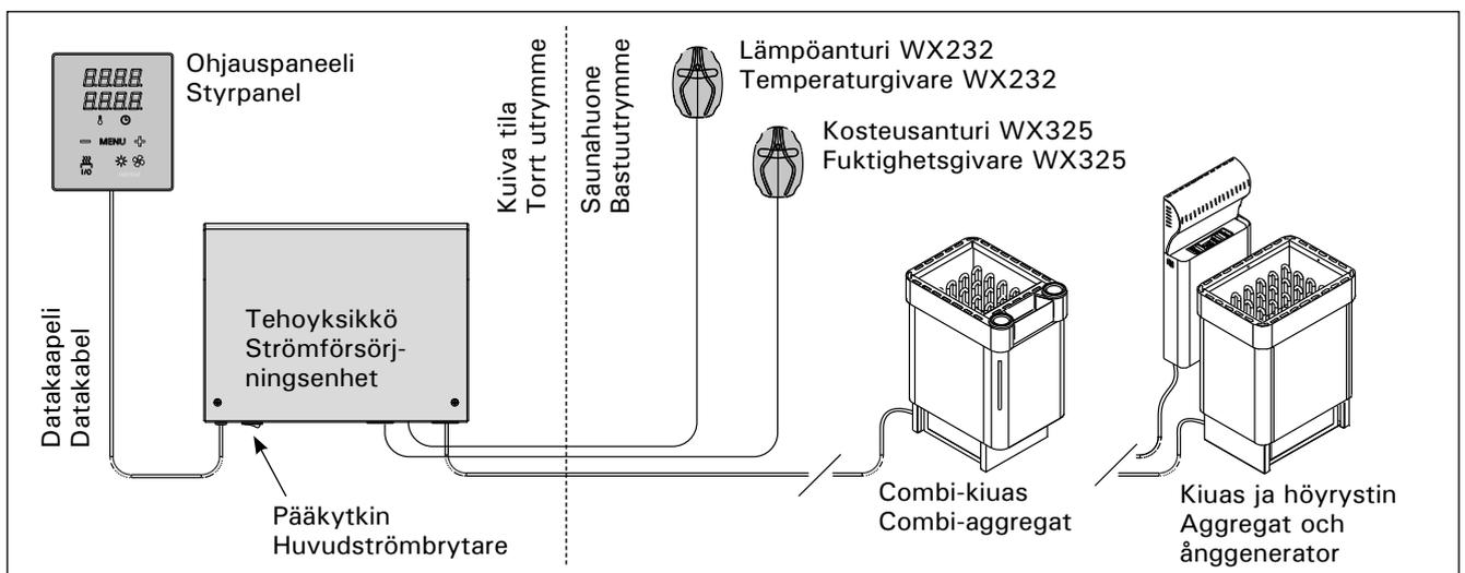
Kuva 1. Järjestelmän osat
