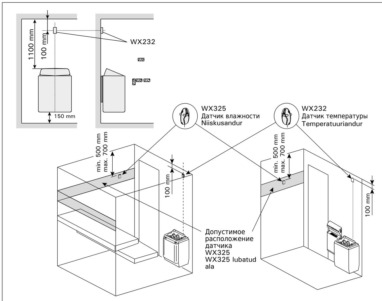
Рисунок 8. Расположение датчиков температуры и влажности относительно настенных нагревателей
