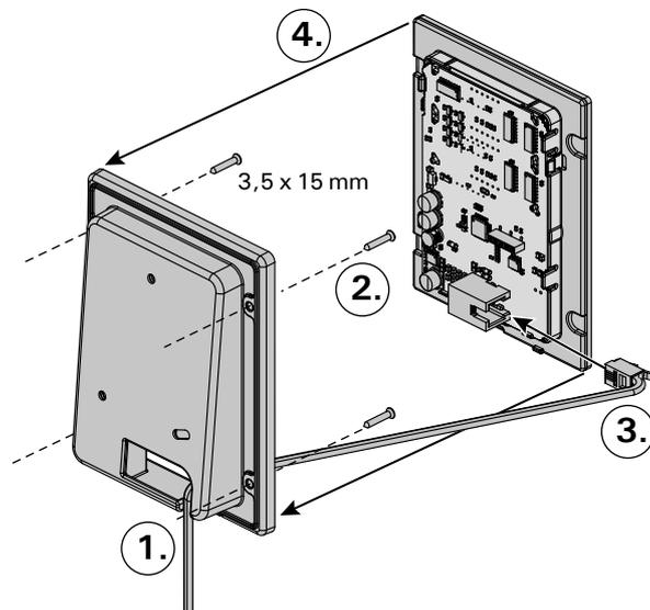
Figure 4. Fixation du tableau de commande
