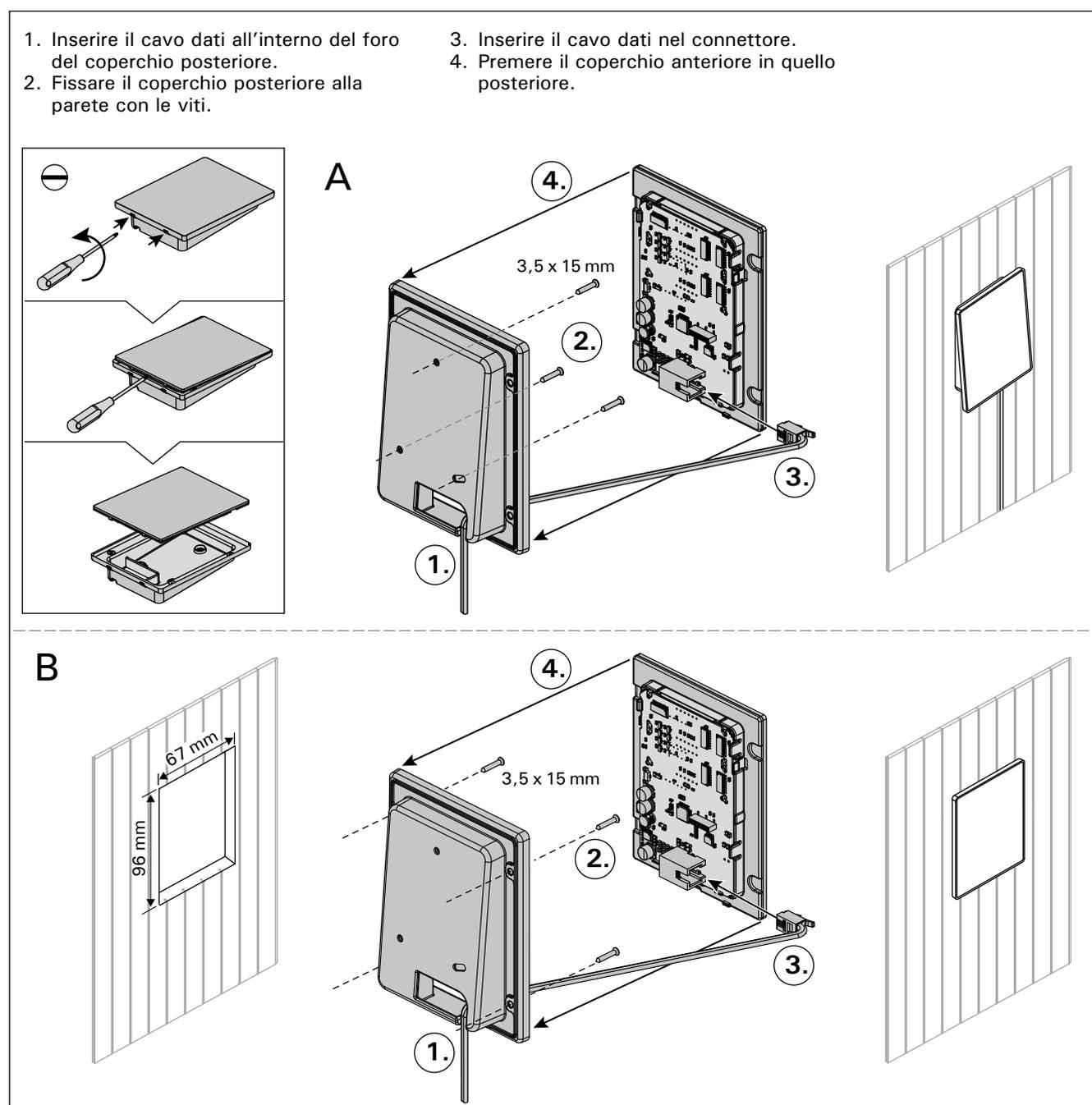
Figura 4. Installazione del quadro di comando
