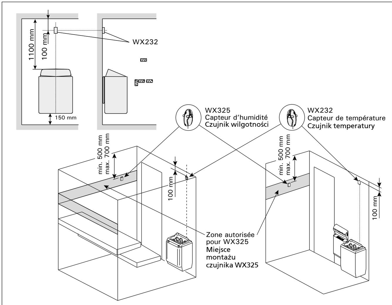
Figure 8. Emplacement des capteurs de température et d'humidité par rapport aux poêles en installation murale
